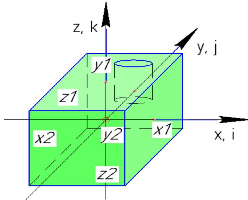
Элементарная ячейка реактора и нумерация граней в ячейке  $i, j, k$
