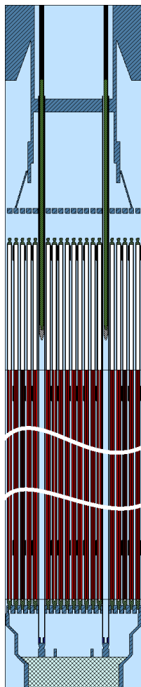
Трёхмерное изображение разработанной модели ТВС
