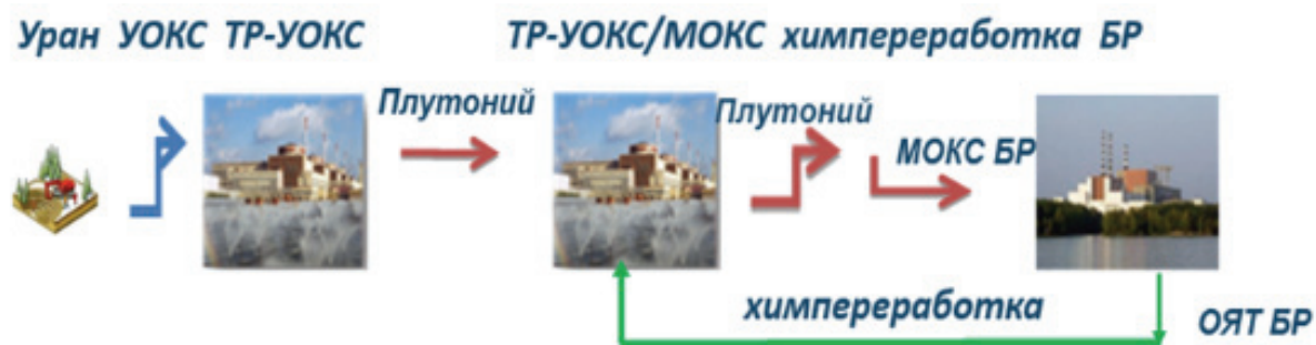
Рис. 6. Схема топливного цикла при многократном рецикле плутония в двухкомпонентной системе тепловых и быстрых реакторов
