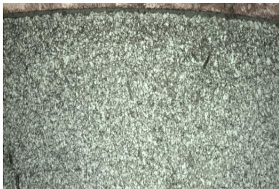
Рис. 1. Микроструктура стали ЭП823 после коррозионных испытаний в свинцово-висмутовой эвтектике длительностью 50 135 ч при  $T = 600$  °С,  $C_{[O]} = (1 - 4) \cdot 10^{-6}$  % по массе
