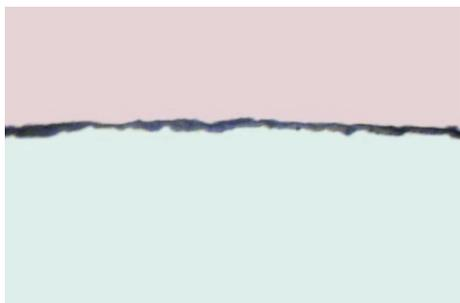
Рис. 3. Микроструктура стали ЭП823 после коррозионных испытаний в свинце длительностью 16 672 ч при  $T=650\text{ }^{\circ}\text{C}$ ,  $C_{[O]} = (1 - 4) \cdot 10^{-6}\%$  по массе
