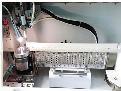
Рис. 2. Установка сортировки МИ по активности
