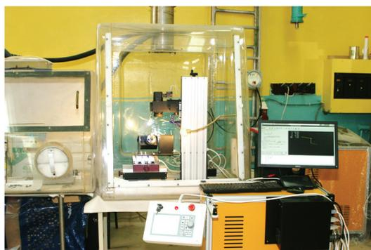
Рис. 6. Установка лазерной сварки МИ
