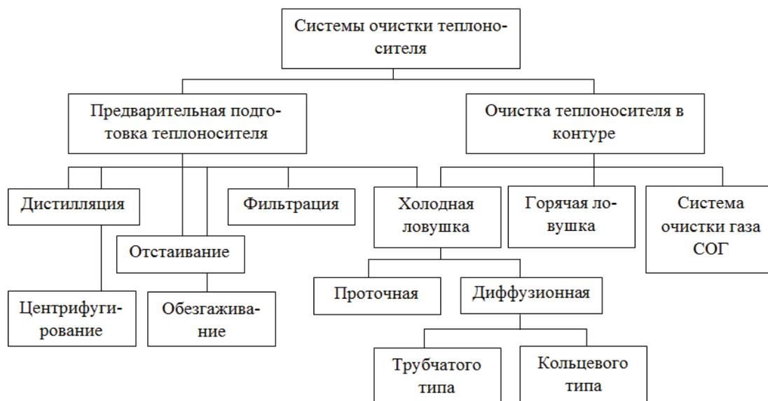
Рис. 1. Системы очистки теплоносителя
