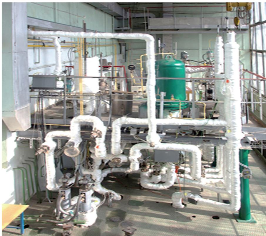
Стенд «ТТ-1М» предназначен для проведения комплексных исследований по технологии свинцового теплоносителя. Направления проводимых на стенде «ТТ-1М» экспериментальных исследований включают:
