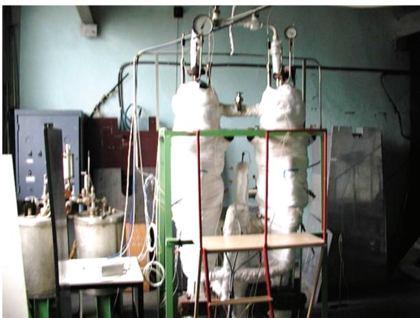
Рис. 1. Экспериментальная модель для исследования кипения натрий-калиевого сплава в системе параллельных ТВС
