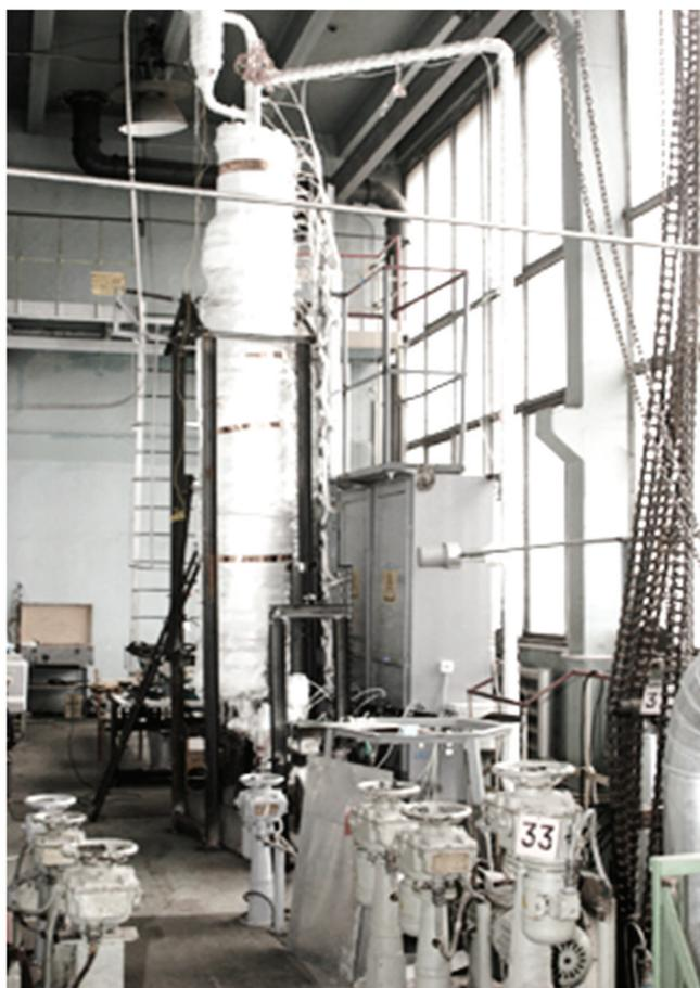
Установка для исследования устройств пассивной аварийной защиты, срабатывающей по температурному принципу
