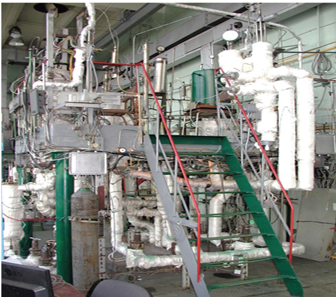
Стенд «ТТ-2М» предназначен для изучения физико-химических процессов, протекающих при взаимодействии тяжелого жидкометаллического теплоносителя Pb-Bi с водой, воздухом, углеродом, керамическими и композитными и др. материалами.
