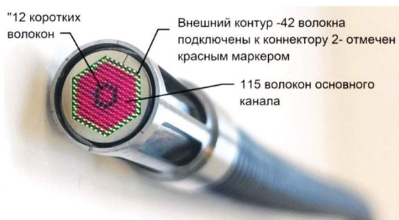
Рис. 3. Внутренняя структура использованного в работе оптоволоконного жгута
