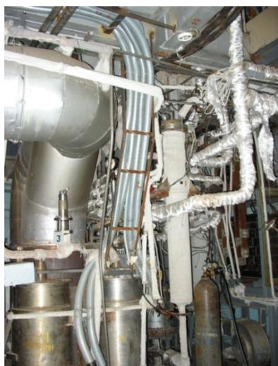
Рис. 3. Натриевый контур для исследования теплообмена в САОТ
