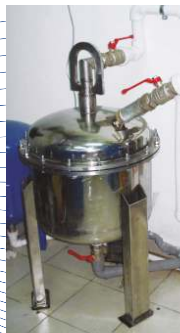
Фильтр производительностью 3500 л/ч
