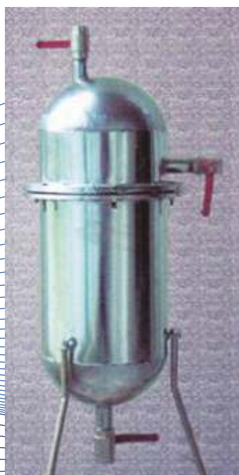
Фильтр производительностью 700 л/ч
