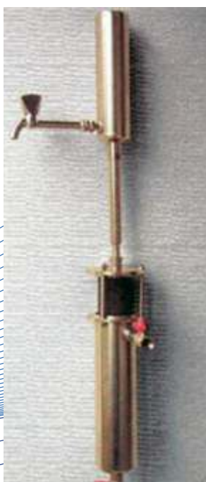
Фильтр производительностью 100 л/ч
