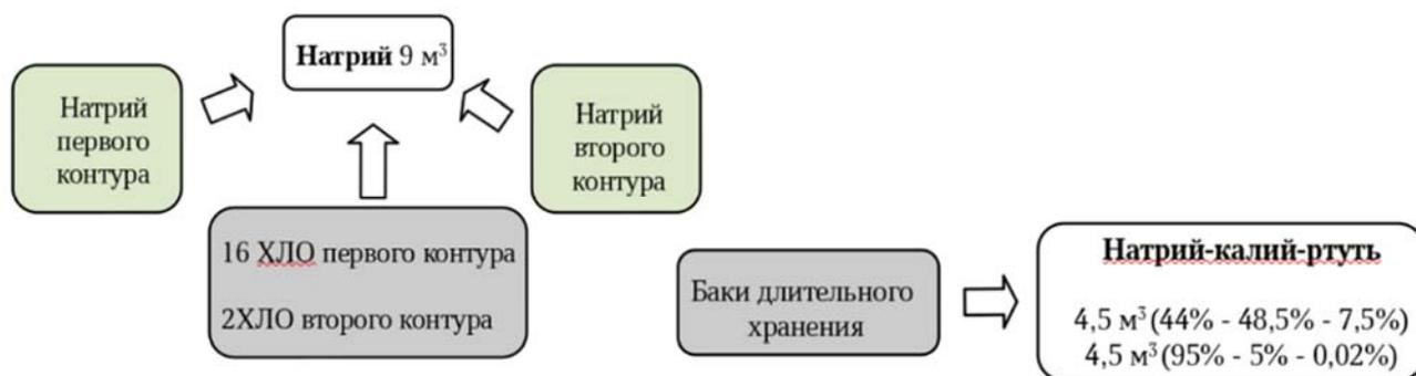
Рис. 1. Состав отходов щелочных теплоносителей на ИР БР-10
