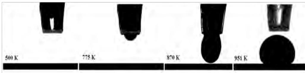
Рис. 1. Схема образования капли заданных значений размеров и компонентных составов для определения углов смачивания
