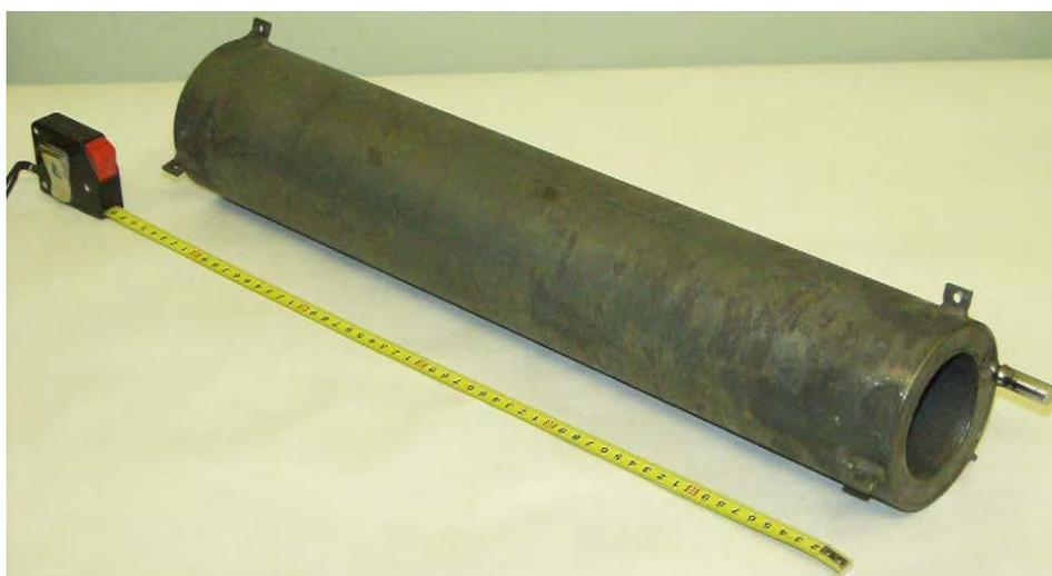
Рис. 7. Термостат для метрологических целей (модель АЧТ)
