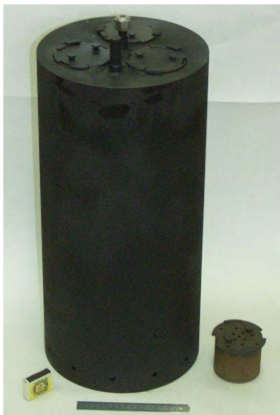
Рис. 4. Высокотемпературный термостат колодезного типа
