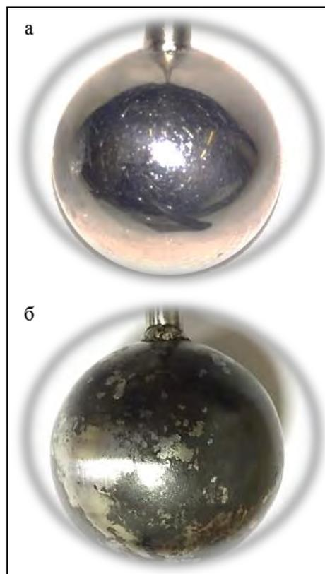
Рис. 4. Фотографии образца из нержавеющей стали с полированной поверхностью (а) и образца из углеродистой стали с коррозией на поверхности (б)
